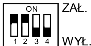
Rys. 12. Fabryczny stan przełącznika grupy wyjść: załączone sekcje 1 i 2, pozostałe wyłączone.
