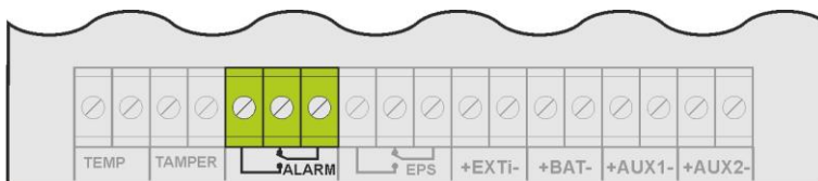
Rys. 7. Wyjście techniczne ALARM.
