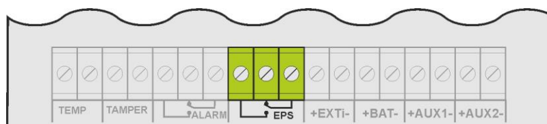
Rys. 7. Wyjście techniczne EPS.
