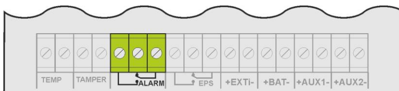
Rys. 9. Wyjście techniczne ALARM.
