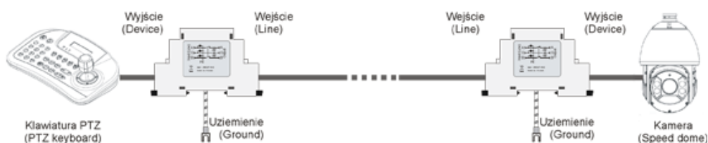
Schemat prawidłowego zabezpieczenia RS-485
