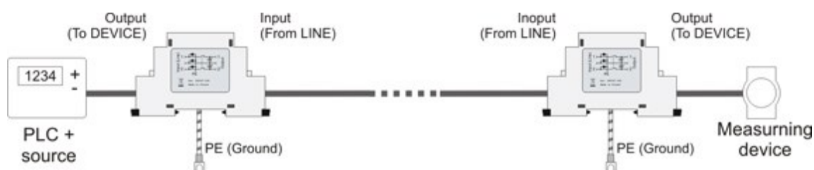
Schemat prawidłowego zabezpieczenia pętli prądowej
