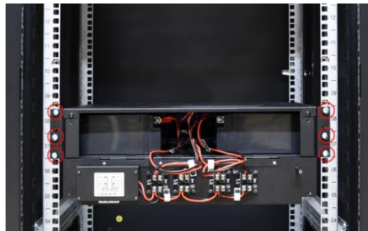
Rys. 4. Sposób wsunięcia akumulatorów.
