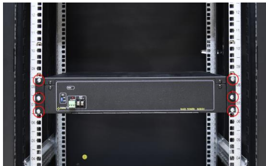
Rys. 3. Sposób montażu kontrolera w szafie RACK.
