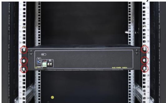
Rys. 3. Sposób montażu kontrolera w szafie RACK.
