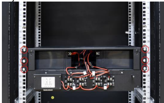
Rys. 4. Sposób wsunięcia akumulatorów.
